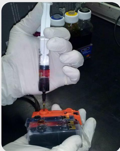
Notará en la imagen como se realiza el purgado. Recuerde tener las entradas de aire de las botellas de tinta abiertas.
