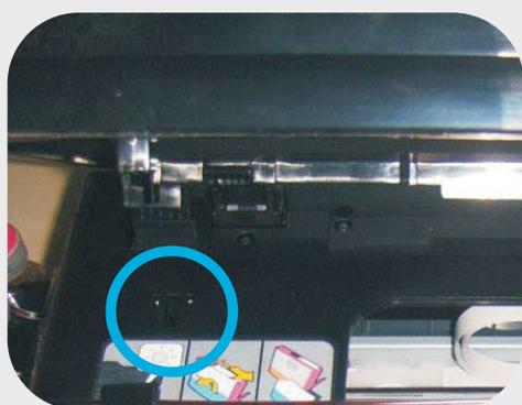
Anule el sensor de la tapa de la impresora, tapando el orificio del mismo como se muestra en la imagen. Para esto debe utilizar el tapón de goma que se incluye en el KIT.
